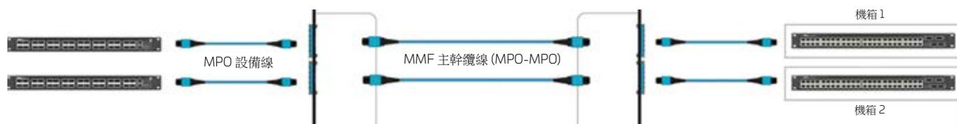
圖 1：使用 MPO 並列式光纖基礎設施連接 SR4 交換器。
