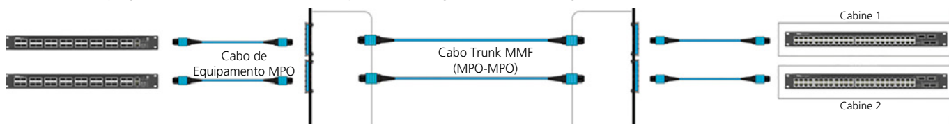
Figura 1: Conectividade de switch SR4 com infraestrutura de fibra paralela MPO.
