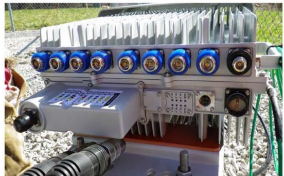
図30:スプリント/サムスンによる8T8Rの実装(米国)
