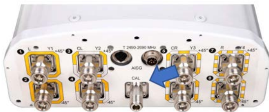
図27:CommScopeアンテナのキャリブレーションポート
